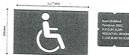
Fig. 5 Señalización "Espacio reservado"
