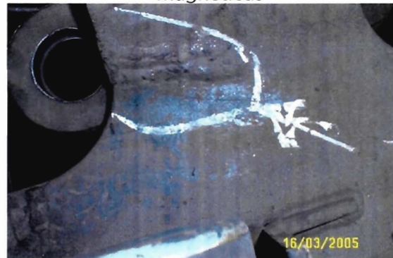
Fisura detectada en inspección visual a bastidor de bogie motriz.
