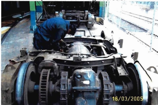
Inspección de fisuras en bogie motriz (inspección visual)
