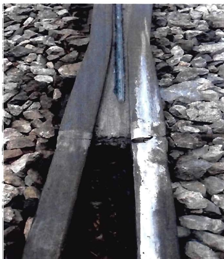
Bisel doble fractura pieza de cruzamiento de juego de cambo numero 5 via 2 fila c pk 1+951
